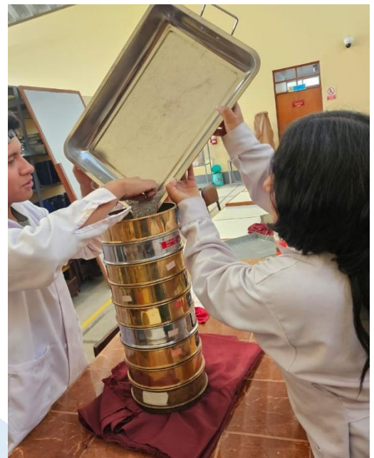
Foto N°6 Ensayo de Granulometría de los agregados (Agr. Fino y Agr. Grueso)
