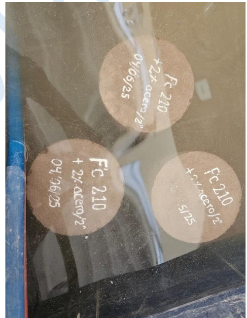
Foto N°15 Curado de probetas por un plazo de 7 y 14 días.
