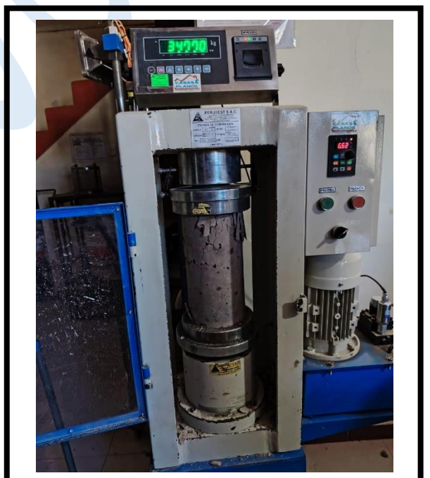
Foto N°19 Ensayo de compresión de probeta con 6% de alambre reciclado
