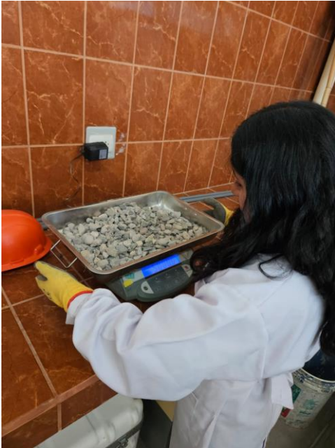
Foto N°9 Pesaje de los materiales a usarse según el diseño de mezclas.
