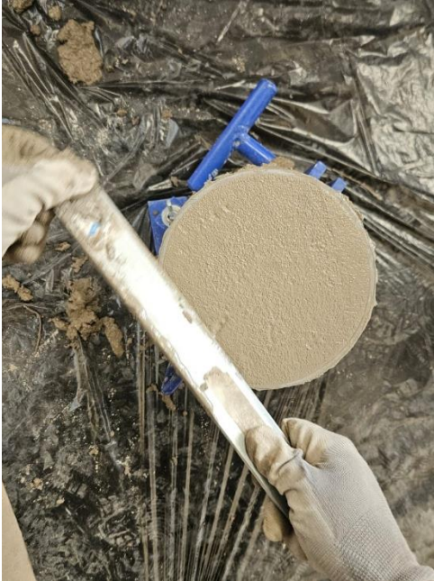
Foto N°12 Enrazado de Probetas a limite de la altura de briquetas.
