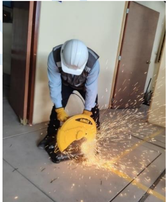
Foto N°4 Corte del alambre N°16 con una tronzadora respectivamente con longitudes de 4 a 6 cm
