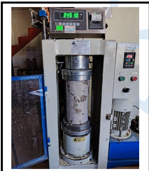
Foto N°18 Ensayo de compresión de probeta con 4% de alambre
