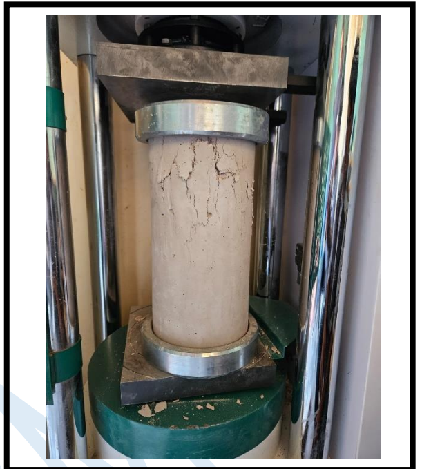
Foto N°17 Ensayo de compresión de probeta con 2% de alambre reciclado
