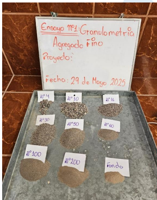
Foto N°7 Muestras del Ensayo Granulométrico respectivamente de cada tamiz
