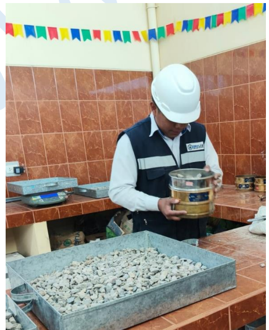
Foto N°8 Tamizado del Agregado Grueso con el uso de los tamices; \frac{3}{4} " y \frac{1}{2} ".
