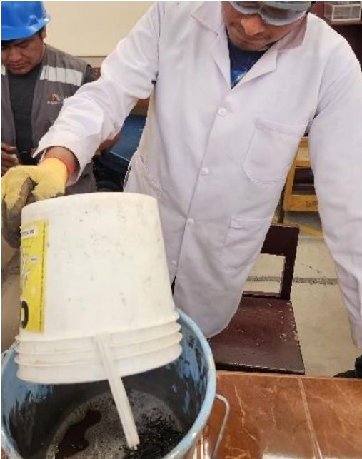
Foto N°5 Acondicionamiento del alambre con el uso de un removedor de oxido
