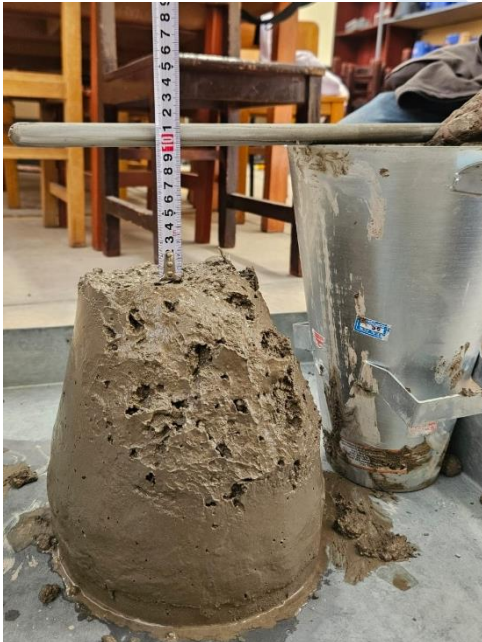
Foto N°11 Ensayo de Análisis de Consistencia del concreto
