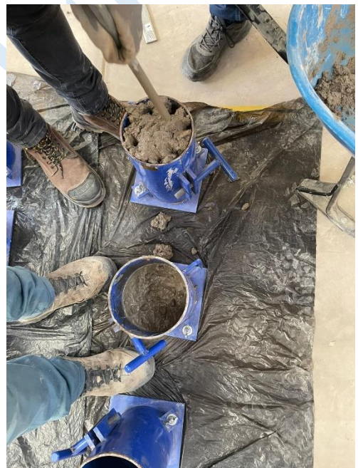
Foto N°12 Vaciado de las probetas previamente acondicionadas.
